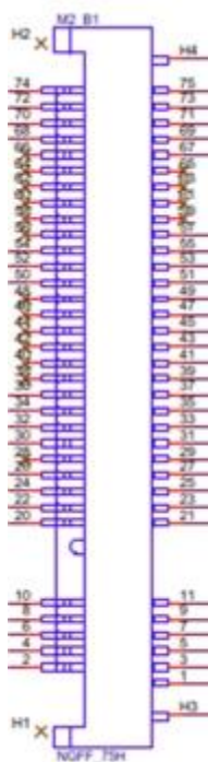
图 2-3 M.2 B-Key 示意图
