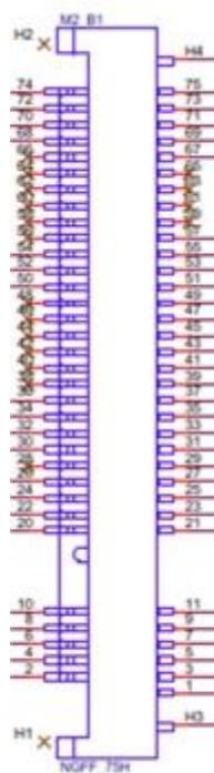
图 2-4 M.2 B-Key 示意图
