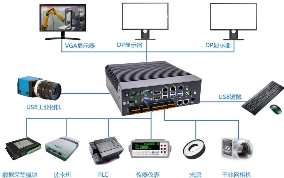
图 3-1：V510 计算机连接图
